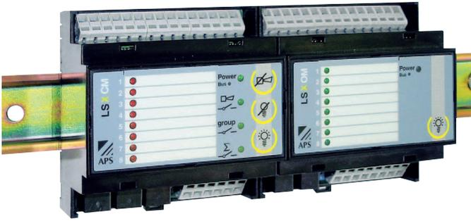
LSX übermittelt Alarm- oder Statusmeldungen über das GSM-Netz. Diese können als Short Message "SMS" von einem Handy oder Pager empfangen, auf einen Fax geleitet oder als E-Mail versendet werden.
